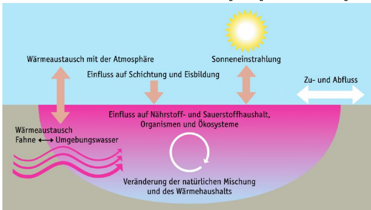
Abb. 4: Prozesse in Seen, welche durch die Einleitung erwärmten Kühlwassers beeinflusst werden können. (Quelle Lanz et al. 2021), bearbeitet.
